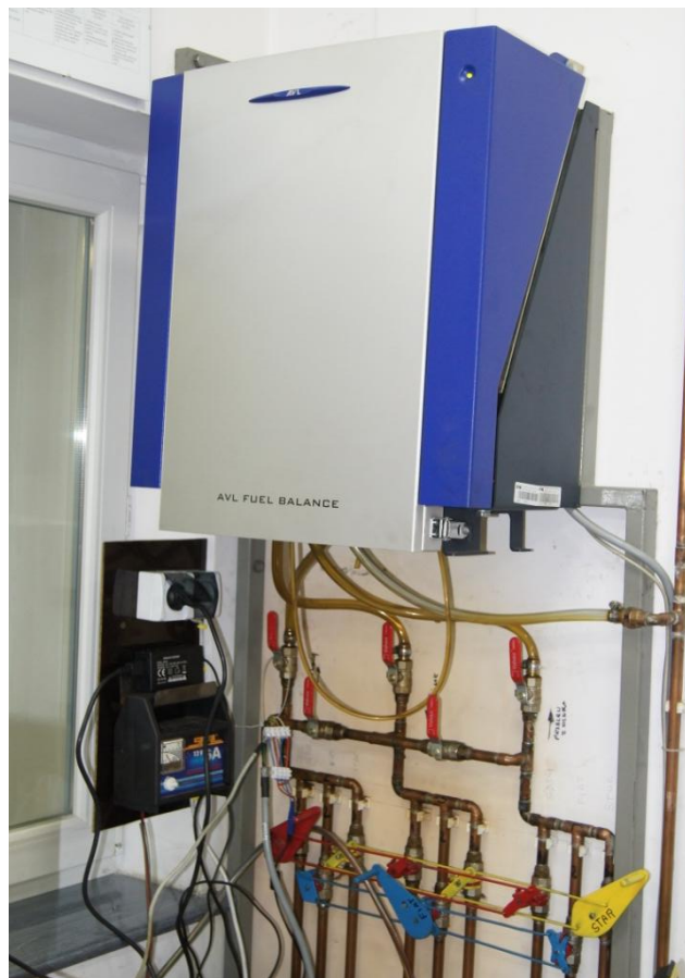
Zd.3.2. Widok ogólny masowej, dynamicznej miernicy zużycia paliwa AVL Fuel Balance
