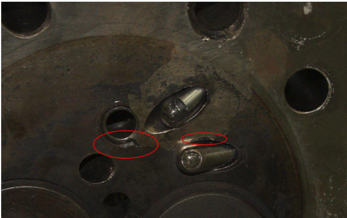
Zd. R1. Widok dolnej płyty głowicy z zaznaczonymi ubytkami spoiny
