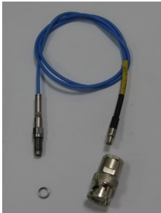
Zd.3.12. Widok ogólny czujnika piezokwarcowego AVL GH 14D do montowania w głowicy silnika SB 3.1 w celu pomiaru szybkozmiennego ciśnienia spalania
