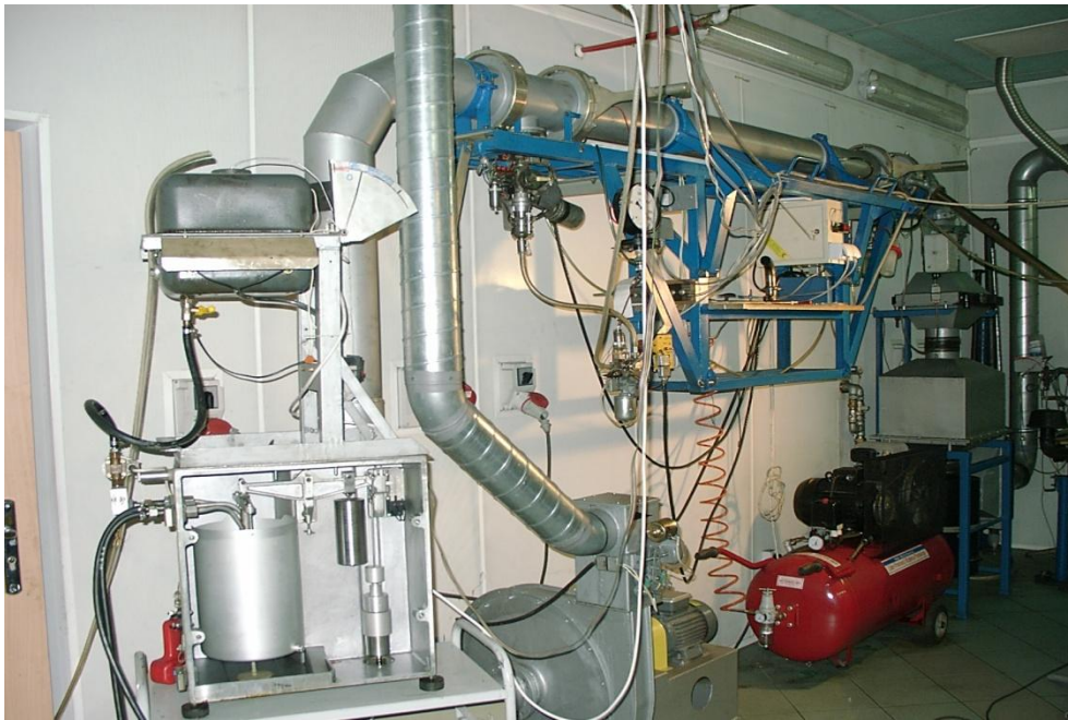
Zd.3.8. Widok ogólny stanowiska pomiarowego z tunelem rozcieńczającym spaliny do określania emisji cząstek stałych PM
