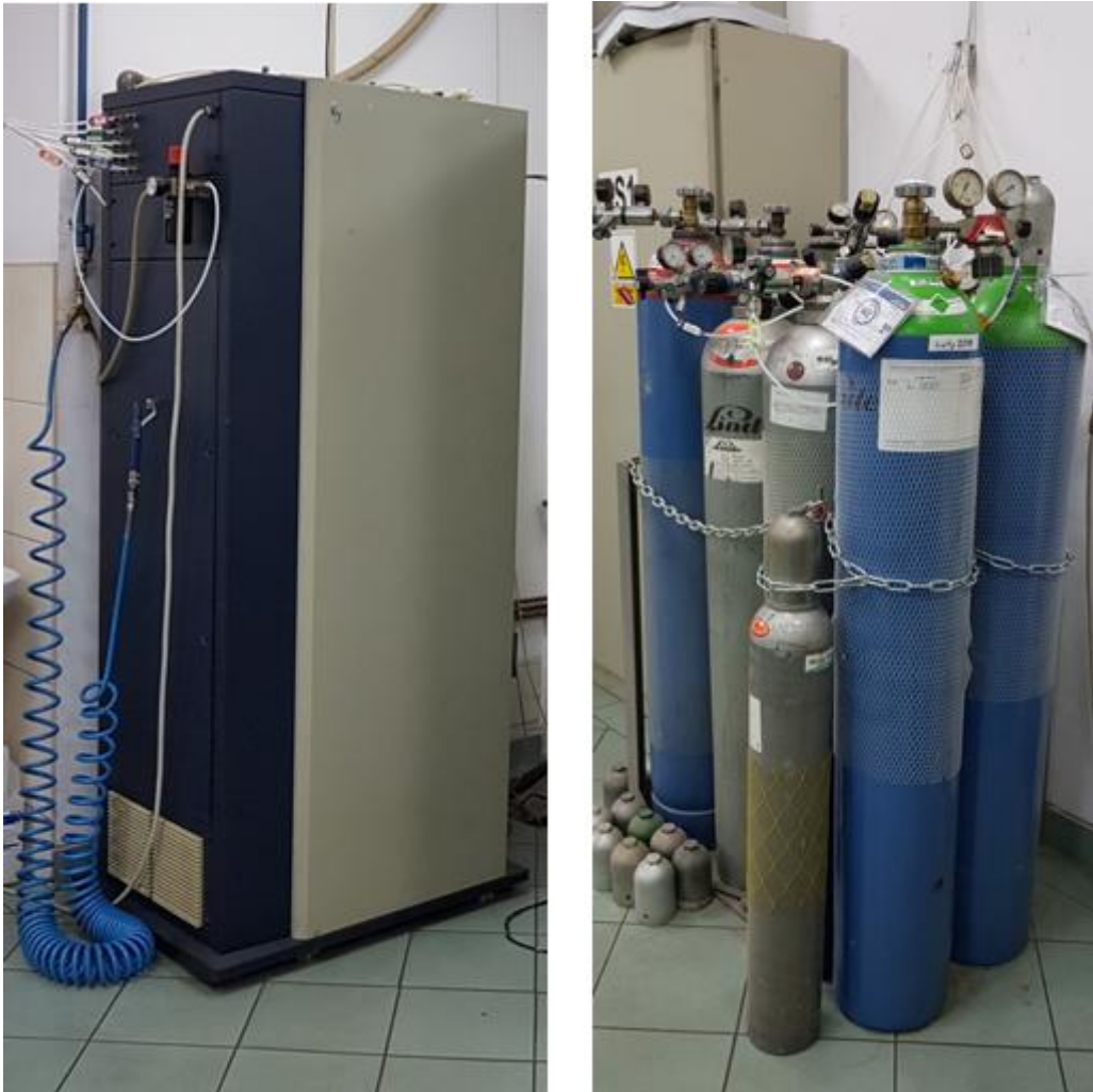
Zd.3.6. Widok ogólny – panel tylny oraz butle z gazami kalibrującymi i roboczymi systemu pomiarowego AVL CEBII
