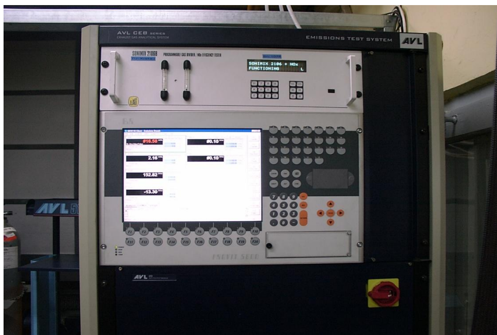
Zd.3.7. Widok ogólny – panel przedni systemu pomiarowego AVL CEBII
